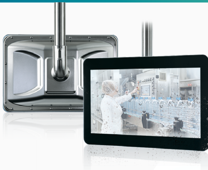
FlatClient HYG – Skalierbarer Panel PC mit IP69K für hygienisch sensible Produktionsumgebungen
